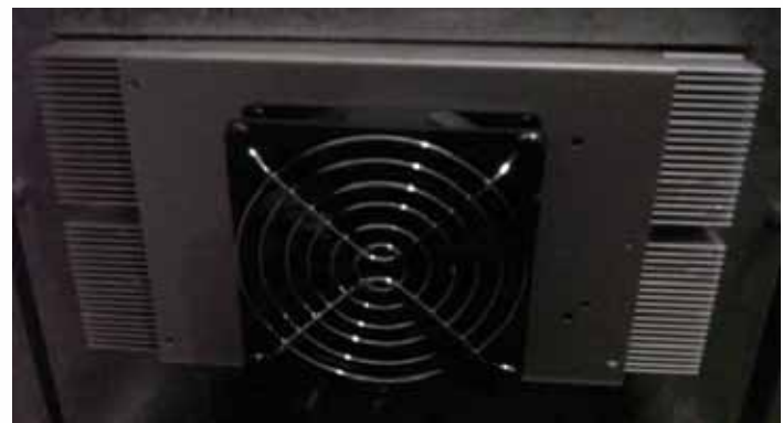
cold sink fan assembly
